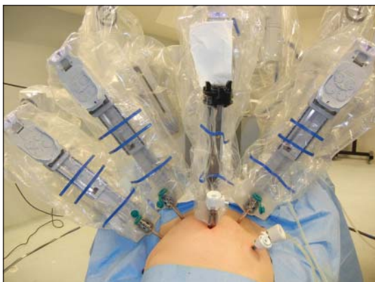
Figura 2. Se aprecia el robot montado sobre los puertos ingresando entre las piernas del paciente.
